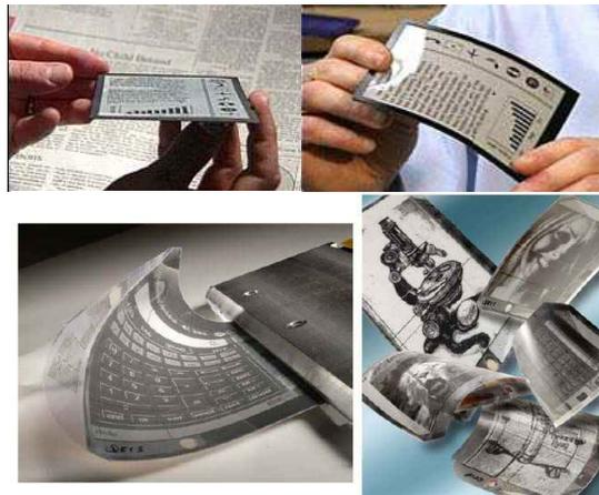
[그림. 12] E-Ink를 이용한 전자종이의 활용 예 (E-Ink, Philips).
