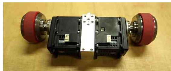
[그림 10] 모터 2개 저속바퀴 두 개 1차 조립
