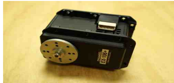
[그림 9] 로보티즈 Dynamixel EX-106
