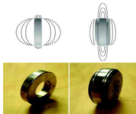
[그림 5] 원형 네오디움 자석과 자력 동작점 변화를 위한 보철 장치
